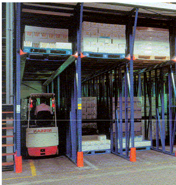
Inrijpalletstellingen, 8 meter hoog voor 20.000 palletposities.
